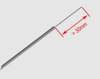
6.Use the miller pliers to strip 0.9 fiber coating. 用米勒钳剥除0.9光纤涂覆层。
